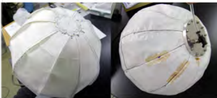
着地時の衝撃を吸収する インフレーターホイール
